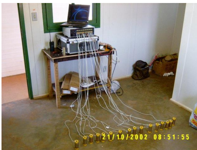
Figura 4.22 - Configuração do registrador de dados antes da instalação no local (ONISHI, 2008).
