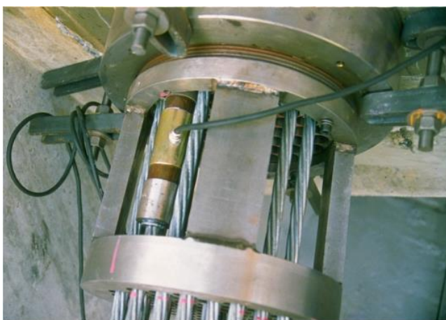
Figura 4.21 - Células de carga inseridas em uma das cordoalhas de cabos de estai (ONISHI, 2008).
